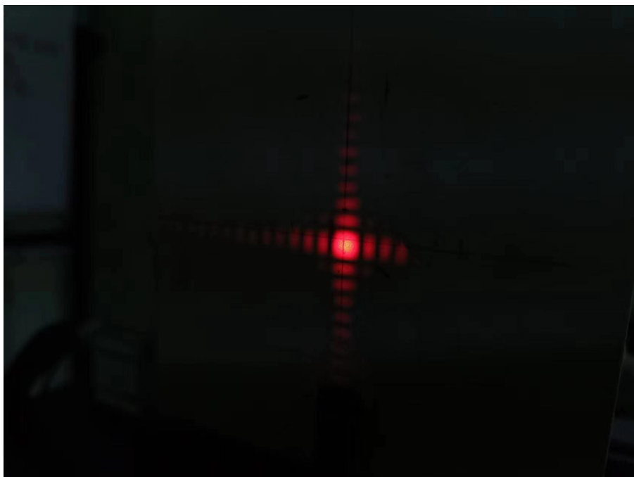
图 8: 单方孔衍射图样
